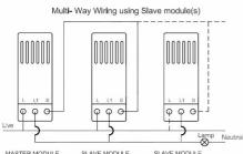
MASTER MODULE SLAVE MODULE SLAVE MODULE ONLY ONE MASTER MODULE IS USED PER CIRCUIT.
